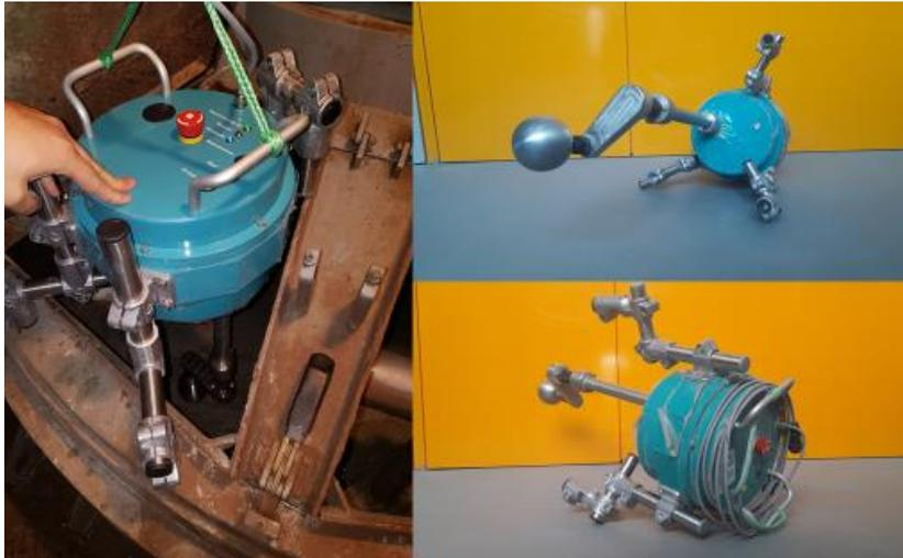
Abbildung 30: Modifiziertes Kugelmesssystem (Betonrheometer) mit der Bezeichnung RheoCT2, Links: Werkzeinsatz in einem Planetenmischer
