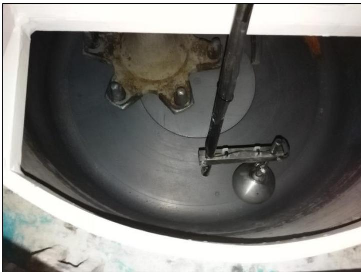
Abbildung 27: Die Messkugel bzw. der Scherkörper befindet sich in der Startposition. Die Messung erfolgt von oben gesehen in einer 140° Linksdrehung
